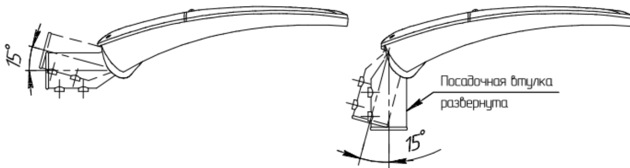
Рисунок 1.2 – Углы наклона светильника
